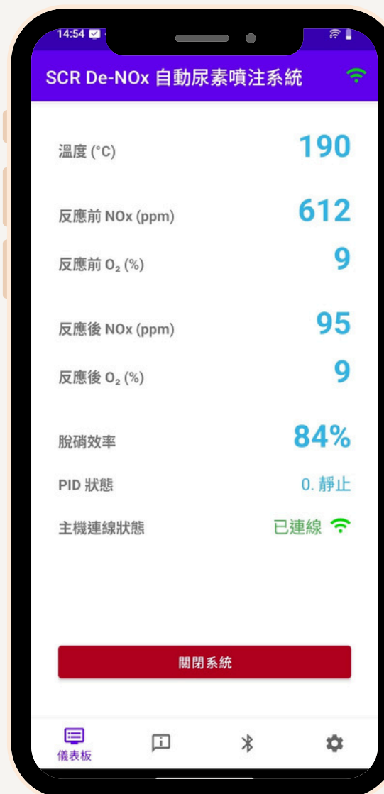
挖土機啟動後，排氣溫度190°C 反應前NOx值約612ppm
