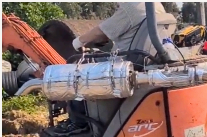
SCR雙載體塗覆觸媒 (含封裝)
